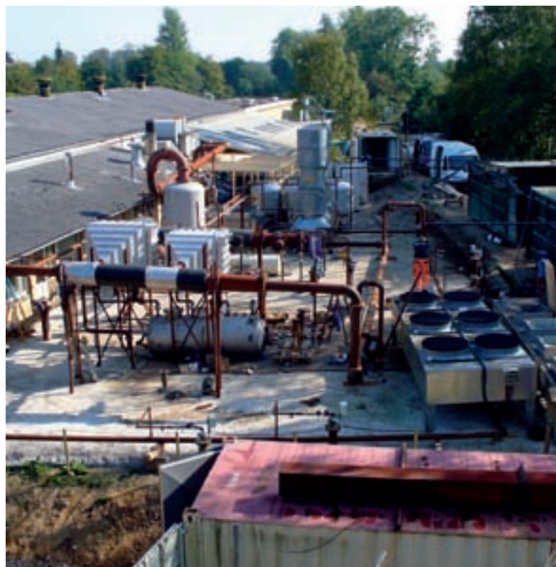
Foto: Miljøoprensning (dampstripping) af tidligere renserigrund i Rødekro
