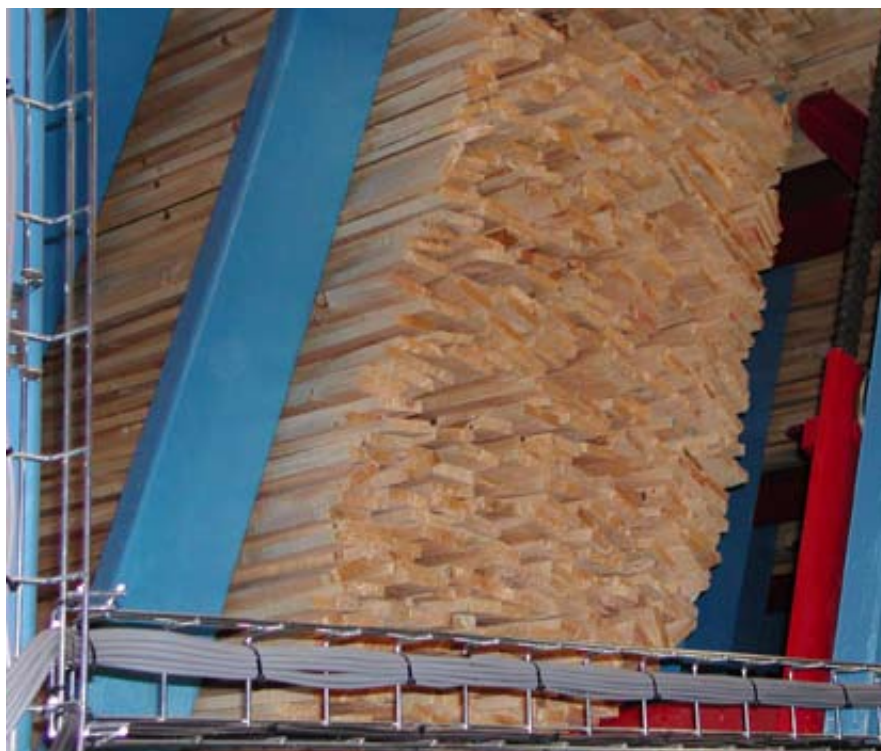
Sjunkfacken i råsorteringen minimerar skador på virket.
