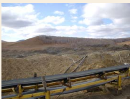
På detta rullband sänds den krossade malmen upp till lagningsplattformarna
