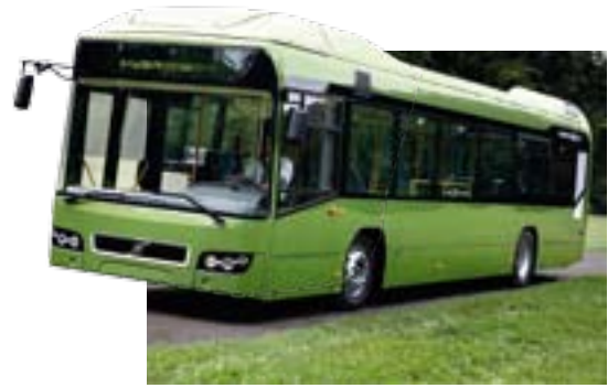
Volvo 7700 Hybrid finns tillgänglig från 2009. Hybriddriften innebär bränslebesparingar på upp till 30%.
