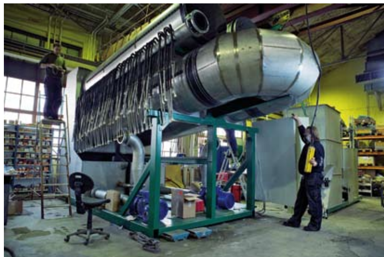
Tillverkning av utrustning för rökgaskondensering vid en av Opcon Bioenergys produktionsanläggningar i Sverige.
