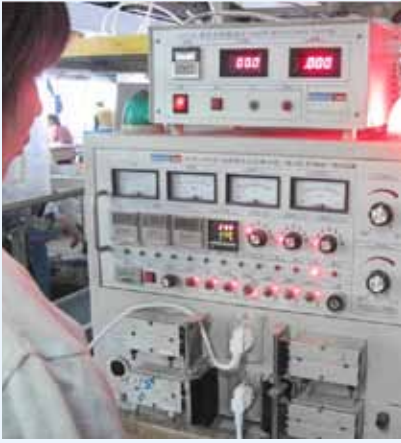
Testmaskinen slår larm och blinkar rött om något är fel med grenuttaget.
