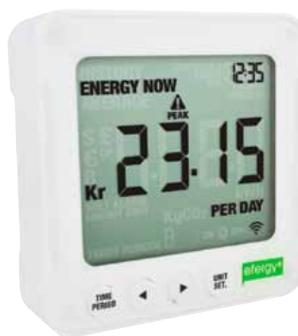
Trådlös elenergimätare med USB-anslutning. Håll kontroll på hela husets förbrukning. Består av tre st. givare, sändare och en displayenhet. Givare och sändare placeras i elskåpet och sänder trådlöst din elförbrukning till displayenheten. Displayen visar sedan kostnad, förbrukning i kWh, genomsnittlig förbrukning samt historik. Storlek på displayenhet: 86x86x24 mm.
