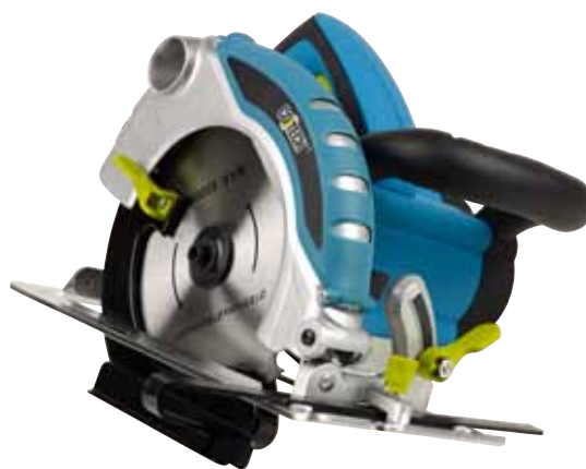
Cirkelsåg Cotech. Med inbyggt spindellås. Sågdjup 63 mm (45° 42 mm). Effekt 1300 W. Varvtal 4700 v/min. Levereras med hårdmetallklinga 185/16 mm och sidoanslag. Vikt 4,3 kg. 30-9985
