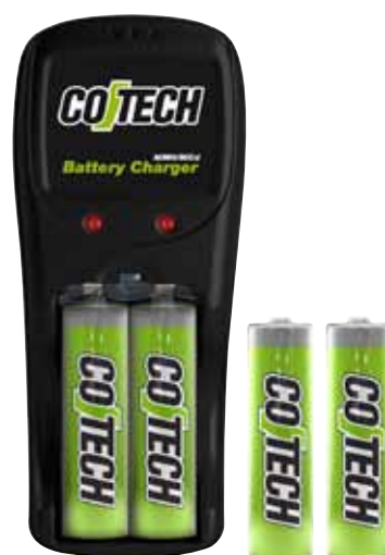
Batteriladdare Cotech. Laddplatser: 2-4 batterier Batteristorlek: HR6/HR03 Batterityp: NiMH/NiCd Laddtid: 12-15 h Laddteknik: Timer Laddstatus: Lysdiodindikering Strömförsörjning: 230 V Inklusive: 4 st. AA/HR6 2000 mAh Ready to Use-batterier. 36-5100
