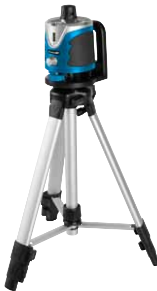
Rotationslaser Cocraft. Tre libeller för nivellering. Horisontell och vertikal referenslinje. Projicerar en 360° linje. Lämplig vid t.ex. uppsättning av tapetbård, lister o.s.v. Stativ, max.höjd 120 cm. Laserklass II, 635 nm. Noggrannhet: 0,5 mm/m. För inomhusbruk. Lev. med laserglasögon, siktskiva, väggfäste, stativ samt väska. 40-7530
