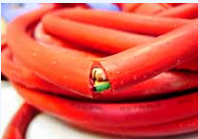
Gummikabelns hållfasthet testas genom att frysas ned till -35 grader i 16 timmar och därefter böjas.
