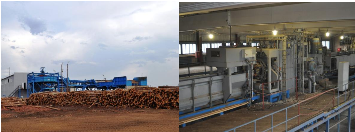
Översikt över timmeranläggningen (till vänster), och den huvudsakliga HewSaw R250 såglinjen (till höger)
