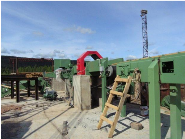
Detaljbild av timmersorteringslinjen, med metalldetektor (till vänster), och den huvudsakliga sågverksbyggnaden (till höger) i Magistralnij den 20 augusti, 2010
