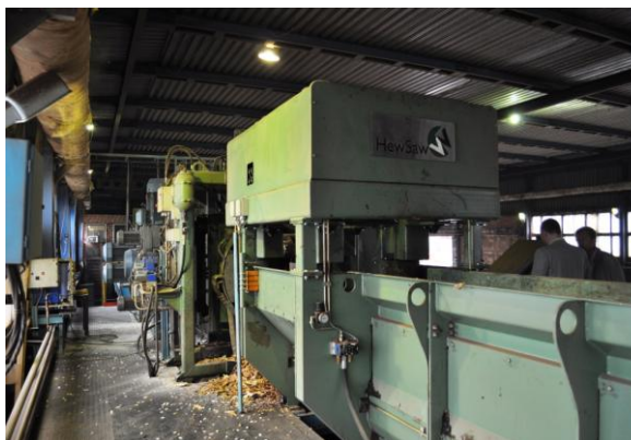
Timmerleveranser under sommaren görs även med präm (till vänster). HewSaw R200 såglinjen (till höger).
