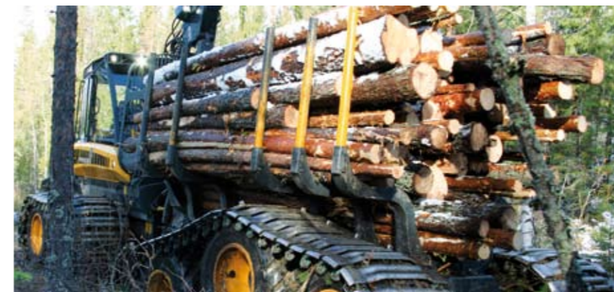
Lokakuussa esiteltiin 10-pyöräinen kuormatraktoriratkaisu heikosti kantavien maiden puunkorjuuseen.
