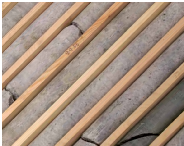
Borrkärnorna granskas och provtas. Resultaten bildar underlag för uppskattning av mineraltillgången.
