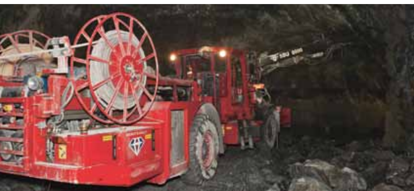
Maskinsrotning efter sprängning
