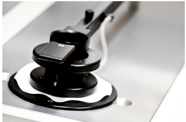
Mätning av porositeten i massan vid Vallviks Bruk.
