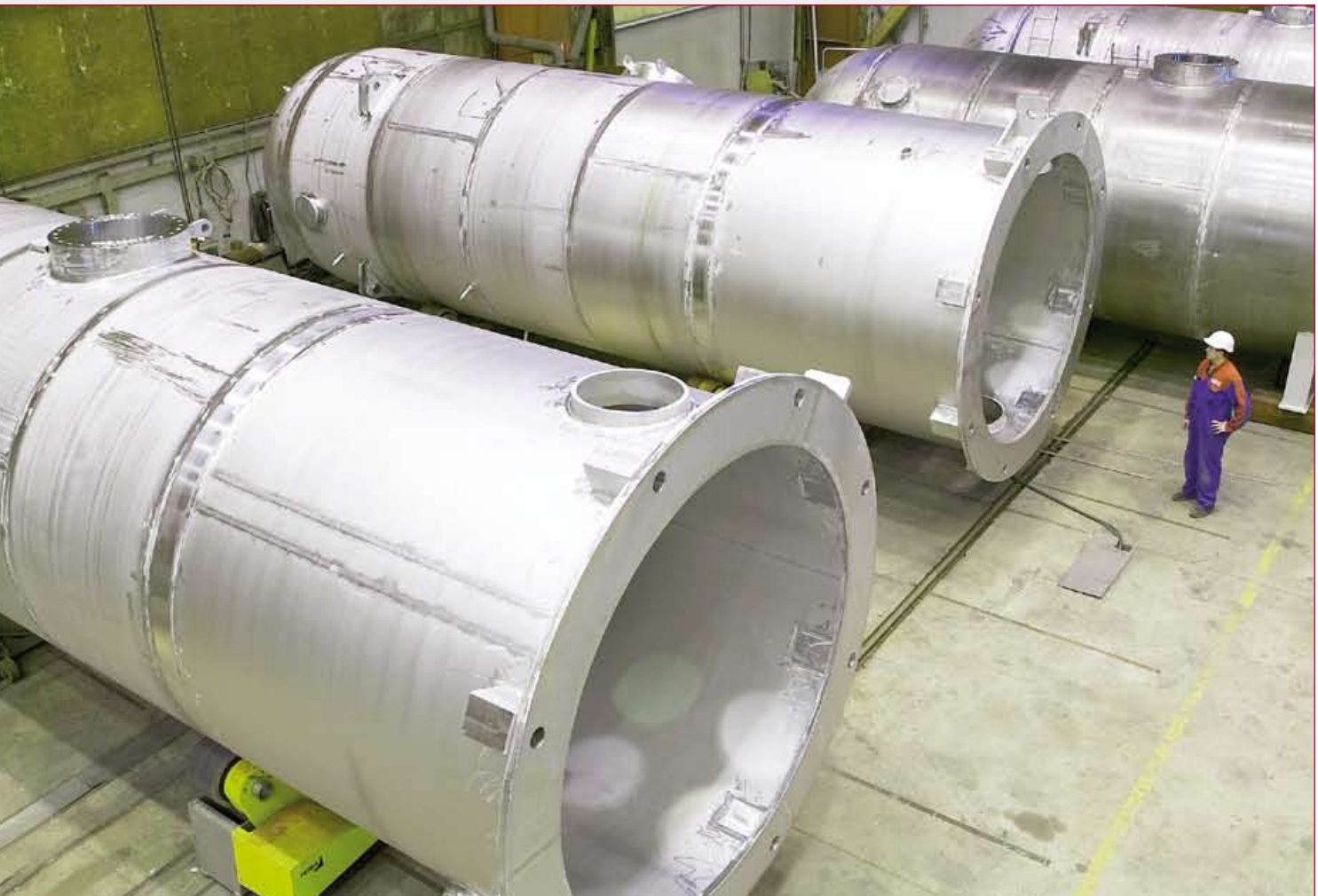
Olkiluodon ydinvoimalan painevesiakumulaattorit toimitusvalmiina Japrotekin tehtaalla Pietarsaassa.
