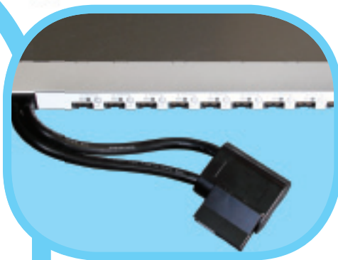
Matkapuhelinverkkokojen tukiasemaan tarkoitettu virranjakoyksikkö mahdollistaa jopa 11 päätelaitteen kytkennän ja etähallinnan.
