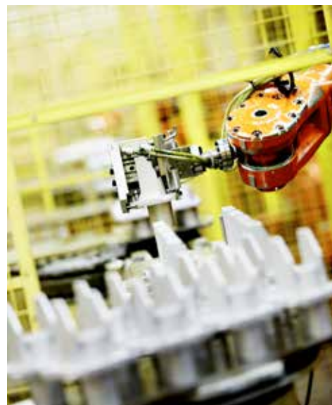
ITB Teknik bearbetar gjutna aluminiumdetaljer, primärt för kunder inom fordons- och verkstadsindustrin.
