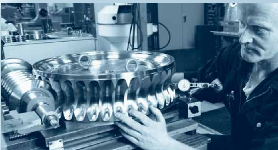
Verifiering av kuggdata på kugghjul hos Mikroverktyg där varje tusendels millimeter räknas.
