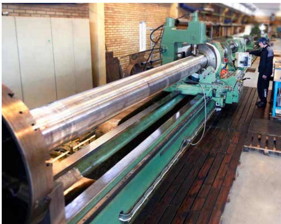
Långhålsbörning i längder upp till 13 m hos KMV i Kungsör.
