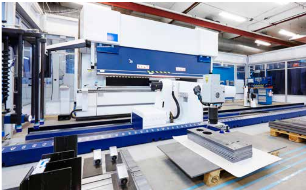
Produktion i helautomatisk bearbetningscell för bockning hos Fredriksons.
