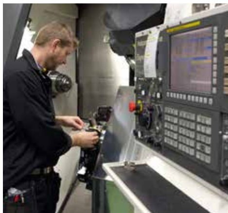
Rigging för ny artikel i fleroptionsvarv hos LK Precision.
