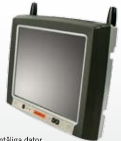
Ett exempel är denna robusta, vattentåliga dator som används i truckar för enklare administrering av lager.
