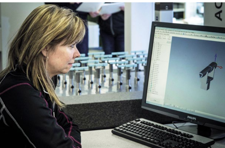
Linda Jespersen ved opmåling af emner til medicokunder på 3-koordinat målemaskine
