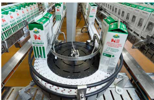
Fredriksons bansystem för hantering av förpackningar. Utrustningen inkluderar såväl transportör- och hanteringssystem som kontroll- och mjukvarulösningar.
