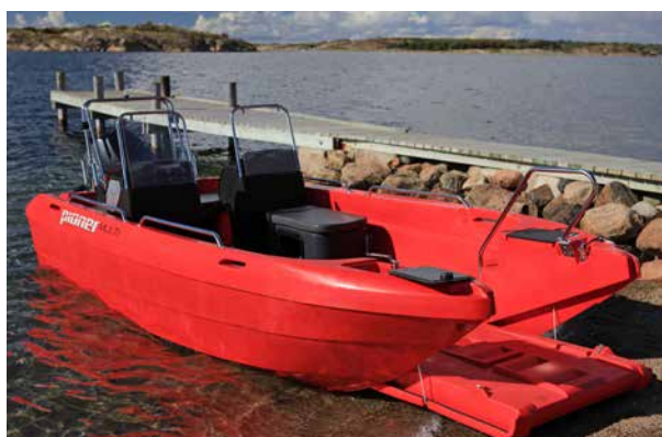
Cipax båt Pioner Multi är rotationsgjuten i ett stycke och kataransskrovet ger goda sjöegenskaper även i hårt väder. Den breda, fällbara bogporten ökar användarvänligheten ytterligare.
