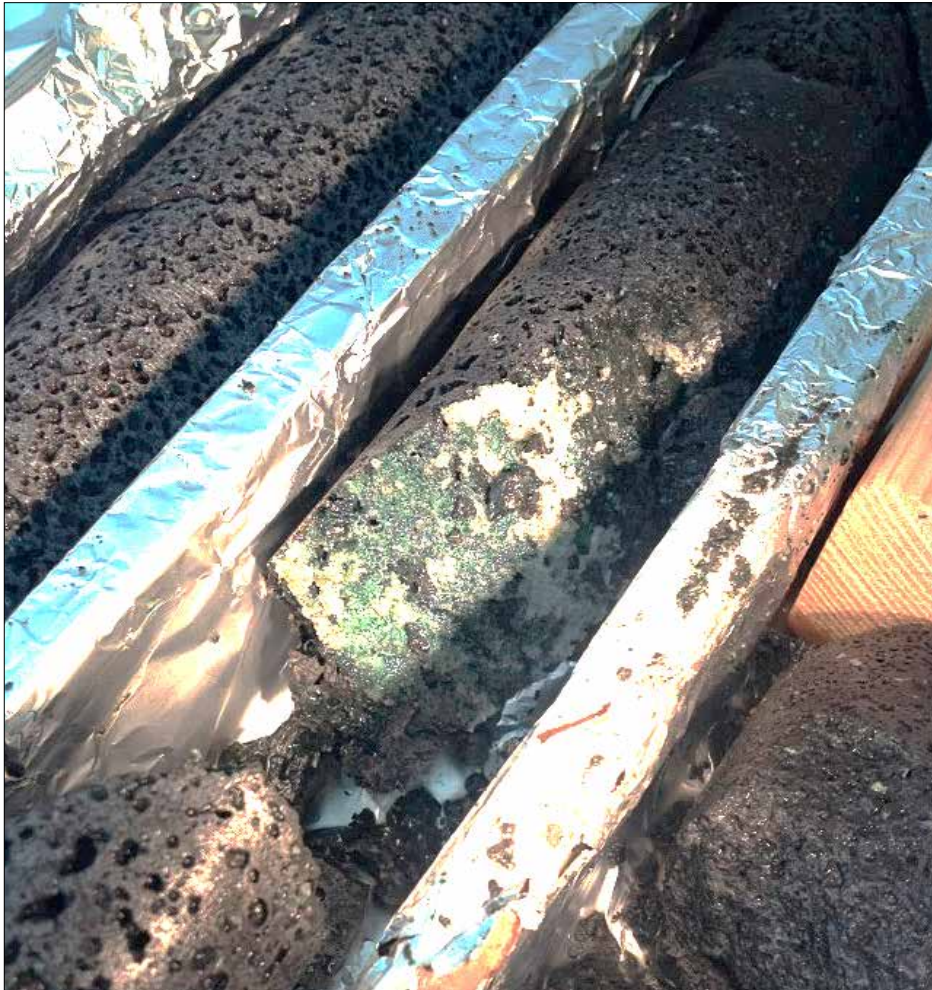
Mynd 22. Útfelling kalsíts í basaltbergglögum á tilraunasvæði CarbFix verkefnisins við Hellisheiðarvirkjun í kjölfar niðurdælingar uppleysts koltvísýrings frá virkjuninni. Ferilefni (græn slika) greina á milli nýrra og eldri kalsítútfellinga. Ljósmynd: Sandra Ósk Snæbjörnsdóttir.
