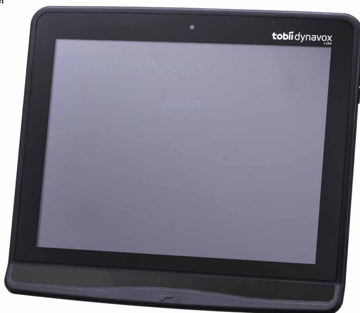
Tobii Dynavox I-12 är en ögonstyrd samtalsapparat som genererar tal och ger access till internet.
