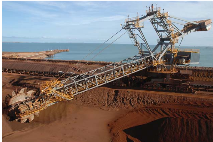
Materialhanteringsanläggningar står för en del av de investeringsrelate- rade projektlösningar som Sandvik Mining and Construction erbjuder. På bilden syns en Sandvik Reclaimer PR200 som arbetar i Port of Dam- pier i Parker Point, Australien.
