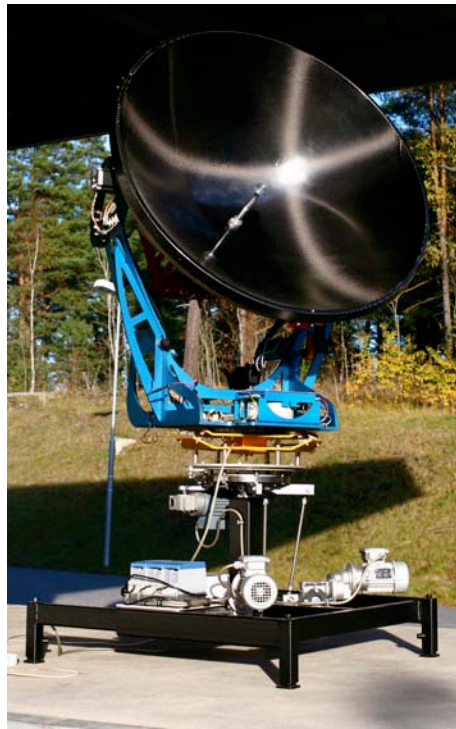
C-Max under utprovning monterad på testbädd för vågsimulering
