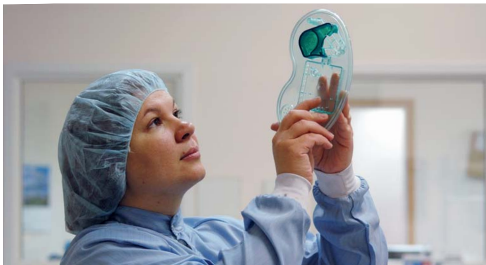
Inmedic arbetar i klassificerad renrumsmiljö (klass 7 och 8 enligt ISO 14644-1) med extremt höga kvalitetskrav. Här utförs visuell kontroll av en ultraljudssvetsad fog.
