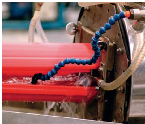
Extrudering av plastprofiler hos Profilspecialisten. Bolaget utvecklar både egna verktyg och egen produktionsteknik.
