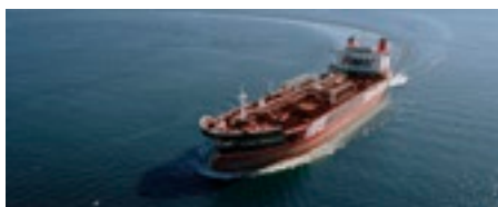
Dubbla roder och propellrar ger snävare svängradie – en stor fördel vid manövrering i trånga passager.
