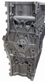
4.3 liter horisontellt V-motorblock Kompakt, aerodynamiskt, hållfast
