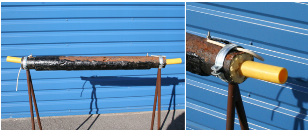
21 paveikslas. Polietileninis vamzdis įvėrimas į seną, susidėvėjusį plieninį dujotiekį.
