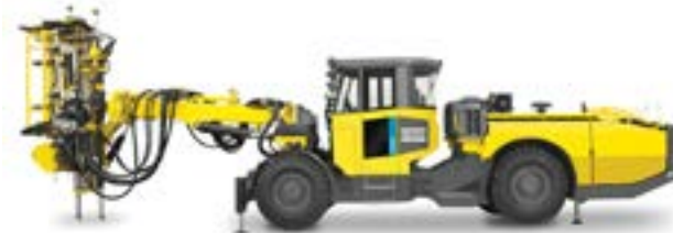
Produktionsborrigg under jord utrustad med smarta automationsfunktioner för högre tillgänglighet av utrustning och förbättrad produktivitet
