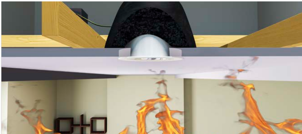
Diamorphs passiva brandskydd har en rad olika tillämpningar. En av dessa är kåpor för infälld belysning i brandklassade innetak. Vid brand sväller kåpan vilket hindrar branden från att sprida sig.
