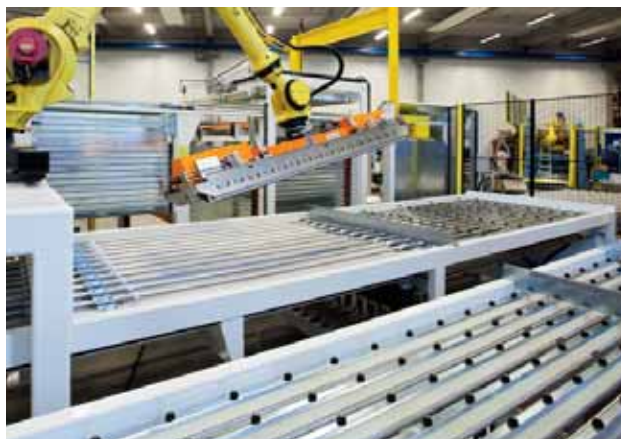
Automatiserad balanseringsutrustning för lock, utvecklad och tillverkad hos NPB.
