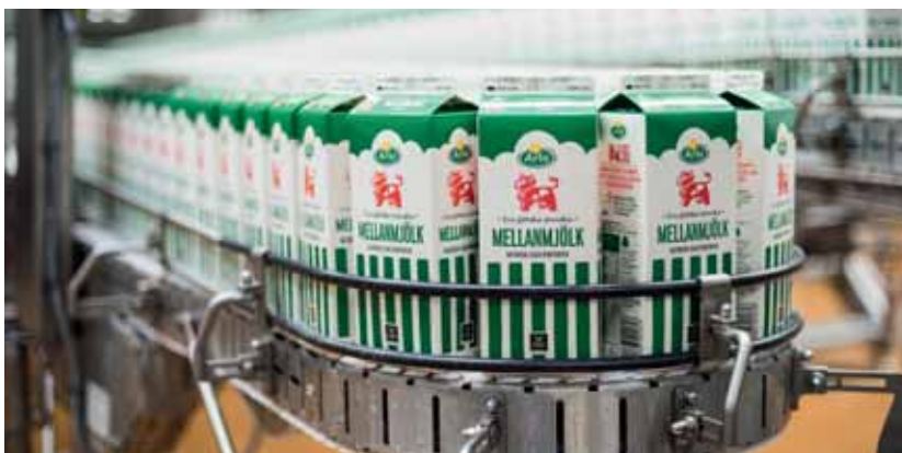
Fredriksons egenutvecklade bansystem för hantering av förpackningar.
